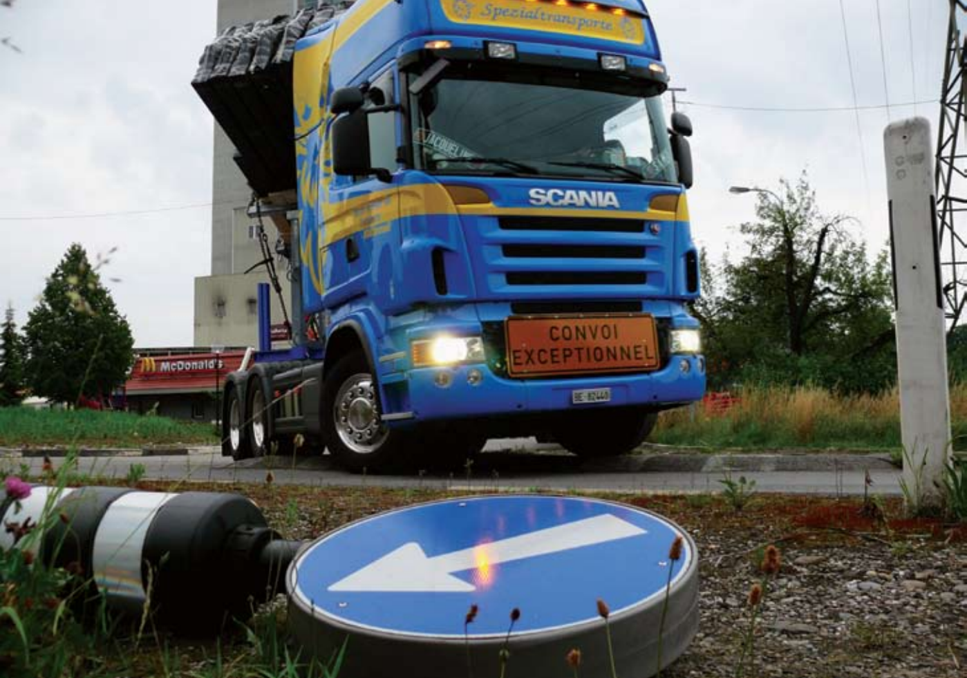
Überlange Fahrzeuge bedingen das Überstreichen von Flächen im Seitenraum von Verkehrskreiseln oder bei Abzweigungen. (Bild: strassenTRANSPORT)
